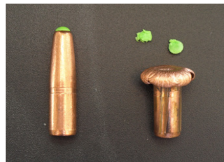
Til venstre ses et almindeligt 9 grams blyprojektil (6,5x55) før og efter indskydning i en dunk med vand. Restvægten i det viste tilfælde er 5,9 gram, mens de resterende 3,1 gram blyfragmenter, ned til støvkornsstørrelse, spredes potentielt i kødet. Til højre ses et kobberprojektil, hvorfra der stort set ikke er fragmenter.
